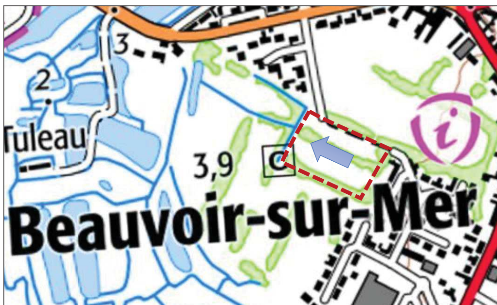
Figure 8 : Schéma d'écoulement des eaux de ruissellement du parcellaire vers le marais (GEOUEST, sur carte IGN, geoportail.fr – Mai 2022)
