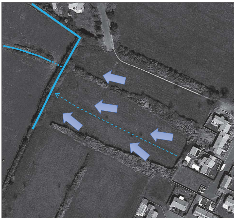
Figure 7 : Schéma d'écoulement des eaux de ruissellement sur le parcellaire étudié (GEOUEST, sur google earth – Mai 2022)
