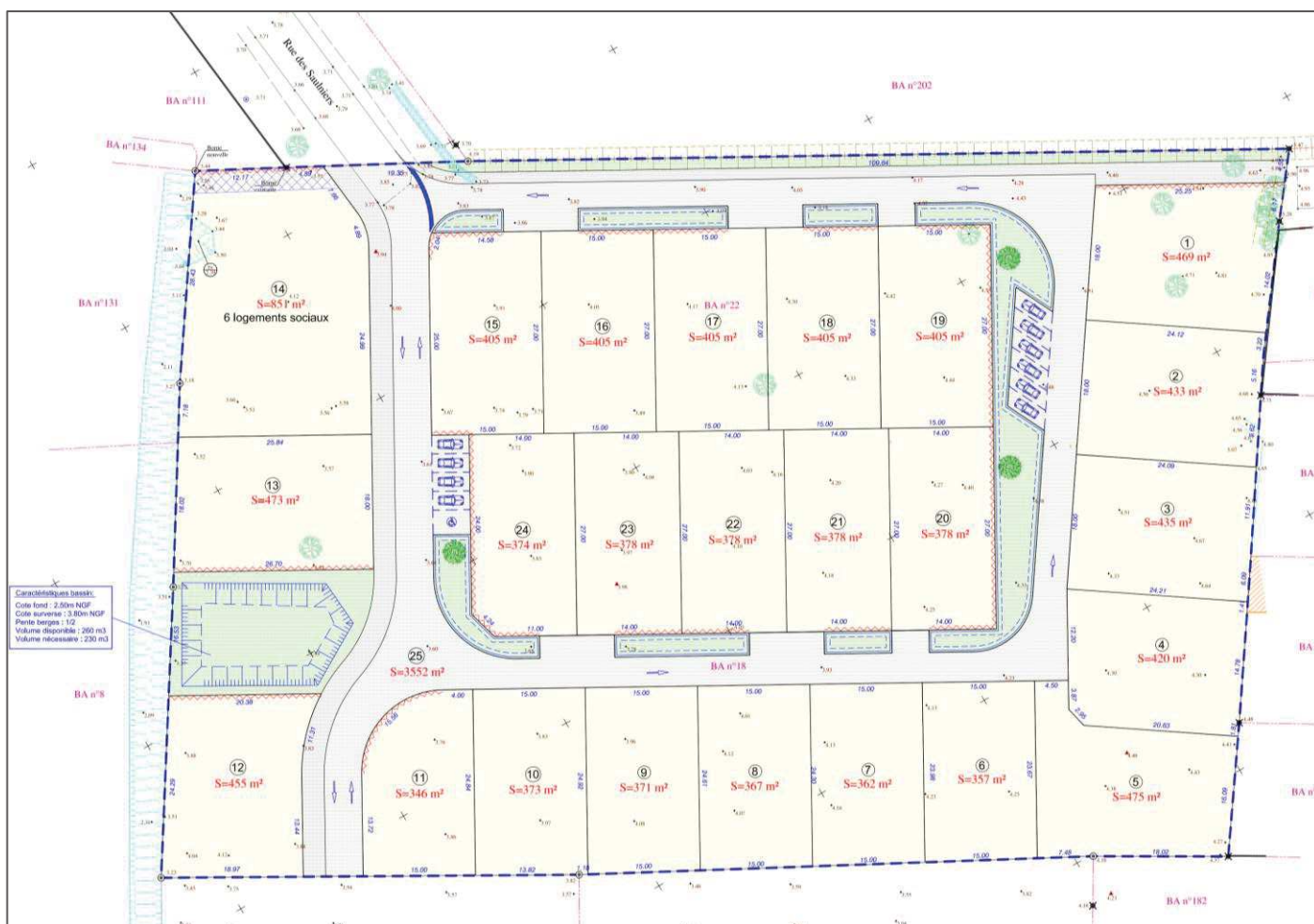
Figure 19 : Plan de composition du projet de lotissement "La Marine" (EURL CESBRON HUGUES, Géomètre-Expert – Mars 2022)
